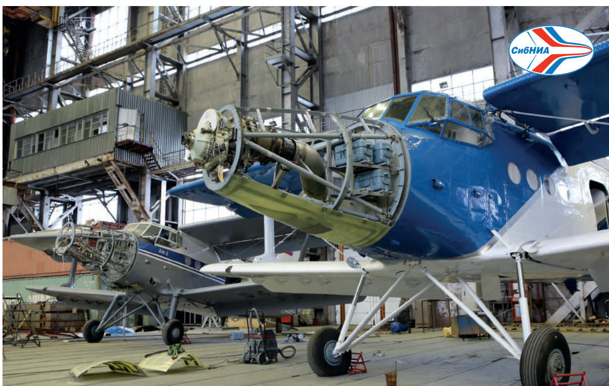
Модернизация и ремоторизация самолетов Ан-2 в СибНИА
