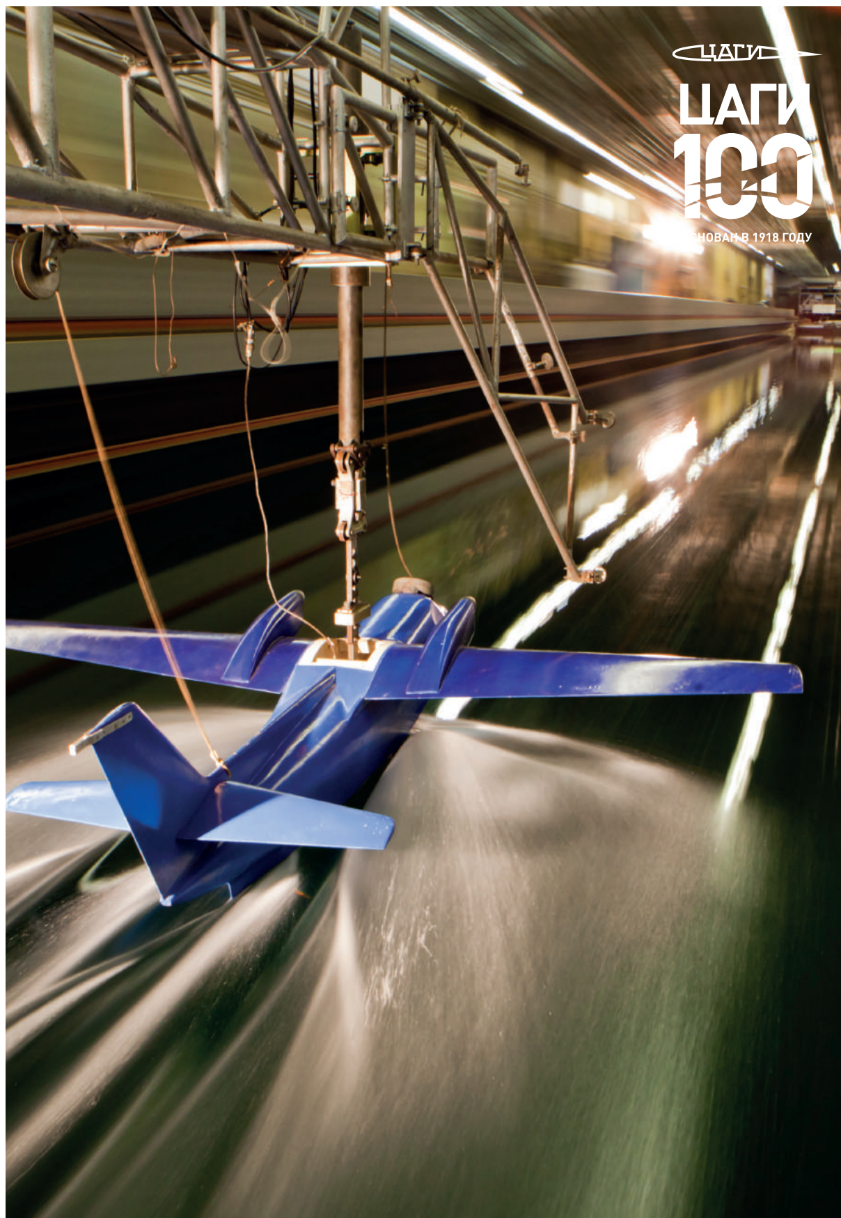
Отработка приводнения самолета-амфибии в гидроканале ЦАГИ
