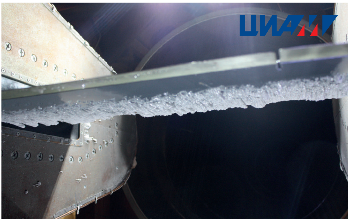
Проведение испытаний в условиях обледенения
