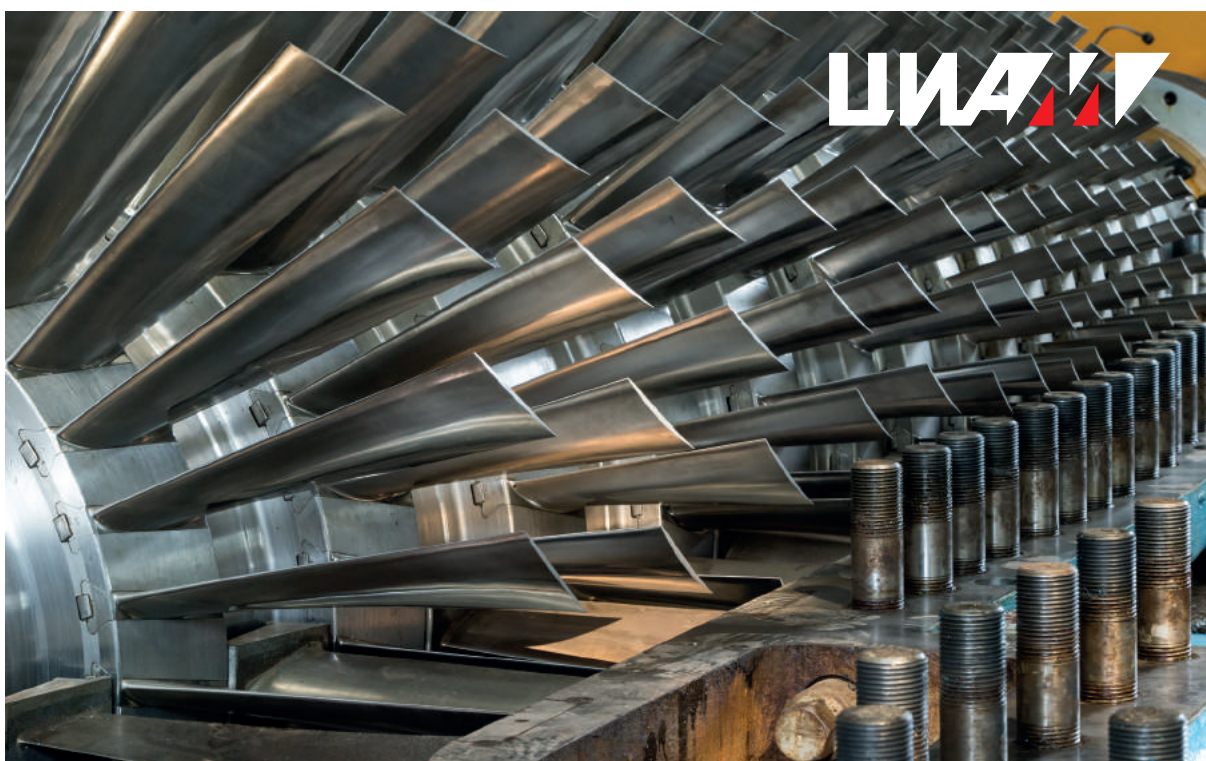
Компрессор высокого давления
