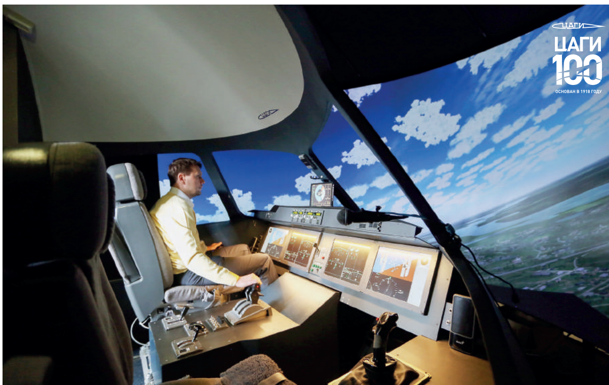
Отработка систем управления самолета МС-21 на стенде ПС-МС
