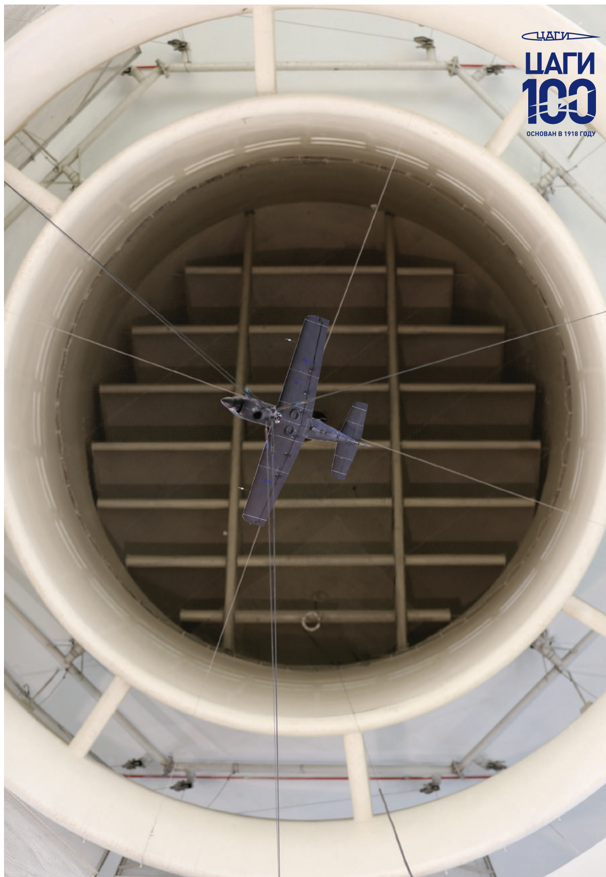
Испытание модели самолета на свободный штопор в вертикальной аэродинамической трубе
