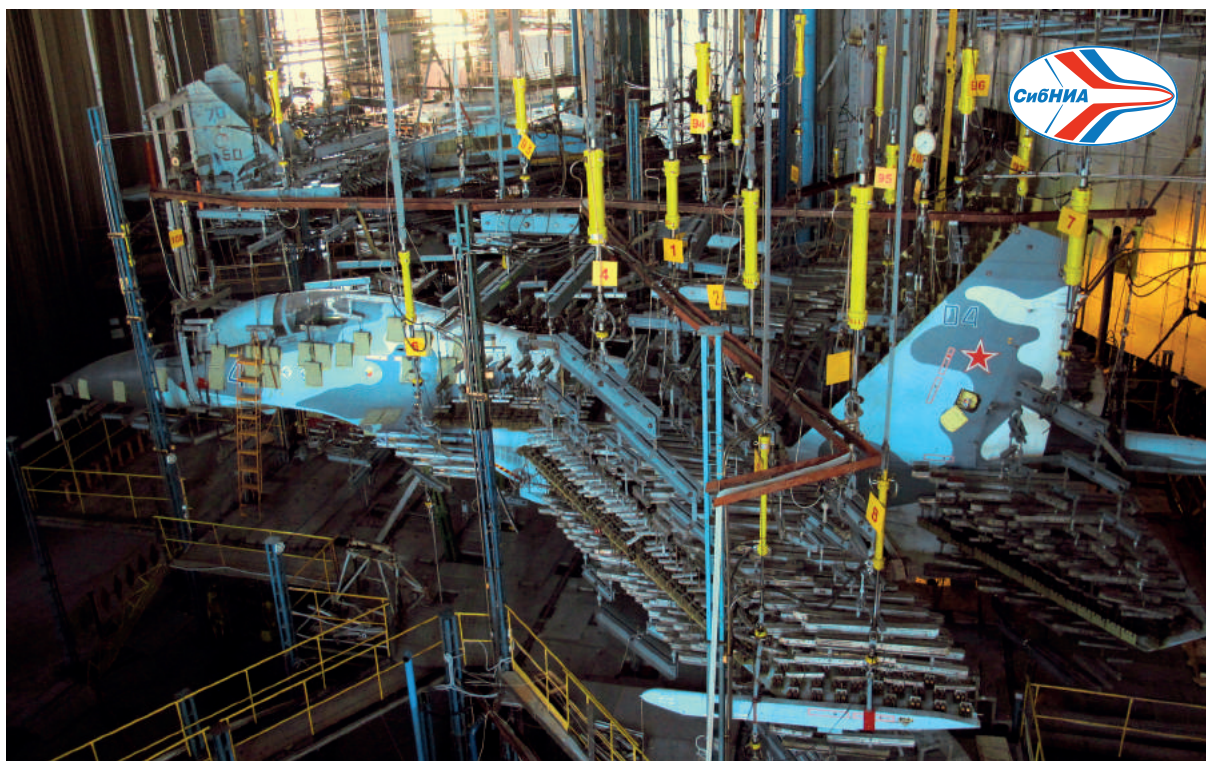
Испытания на усталостную прочность маневренного самолета Су
