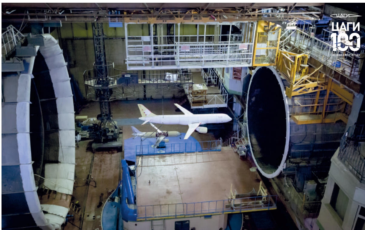
Испытание упругоподобной модели самолета на флаттер в аэродинамической трубе Т-104
