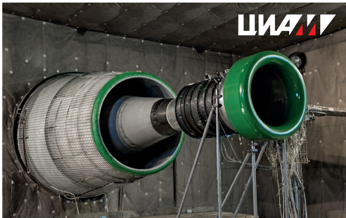
Стенд для исследования аэродинамических и акустических характеристик моделей перспективных биротативных вентиляторов
