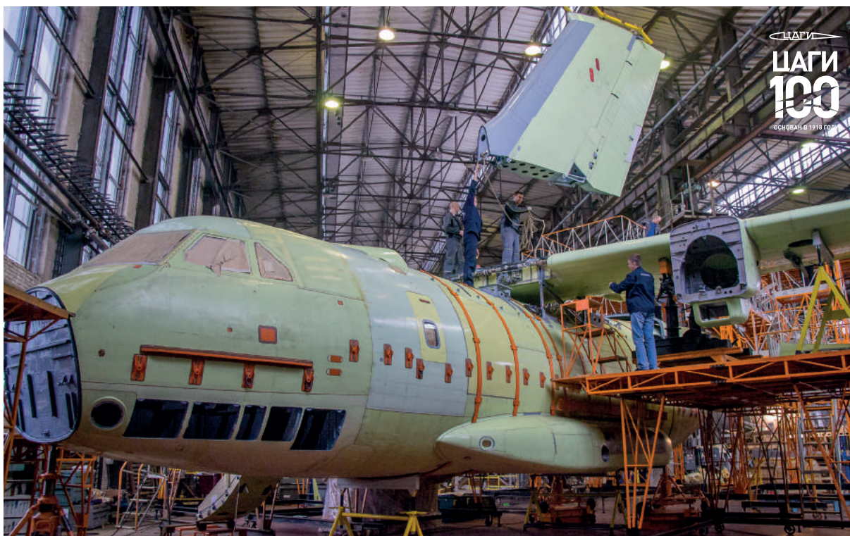
Досборка планера военно-транспортного самолета Ил-112В в зале ресурсных испытаний
